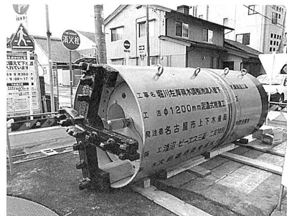
写真-4 φ 1,200mm 泥濃式推進機
