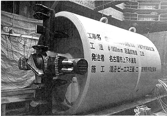
写真一五 φ 1,800mm 泥濃式推進機
