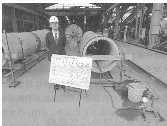
写真-3 E形継手内水圧複合試験
