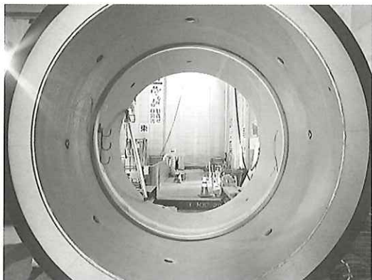
写真-3 注入孔を8ヵ所設けた多孔管
