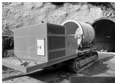
写真－9 推進管運搬 （重量物運搬台車）
