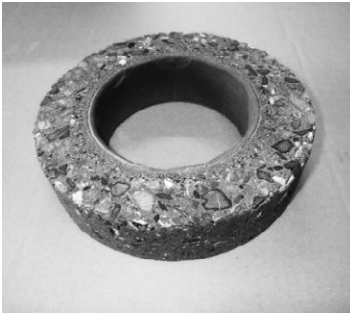
写真－3 5%濃度硫酸水溶液に112日間浸漬した後の状況写真 左 e-CON® 右 普通コンクリート
