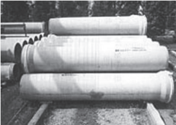
写真-1 粒度調整灰入りのヒューム管
